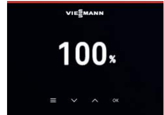
Das 3,5 Zoll große Black-Panel-Display im Bedienteil zeigt den aktuellen Ladezustand der Batterie an. Der Light-guide informiert auf einen Blick über den ordnungsgemäßen Betrieb des Gerätes.
